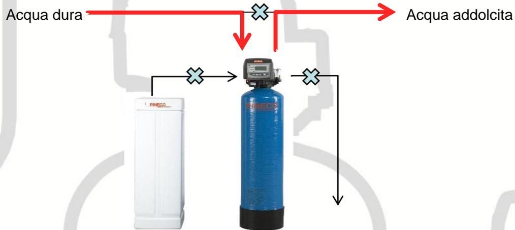
**Fase di rigenerazione:** lavaggio delle resine con salamoia, per ripristinare il potere di scambio
